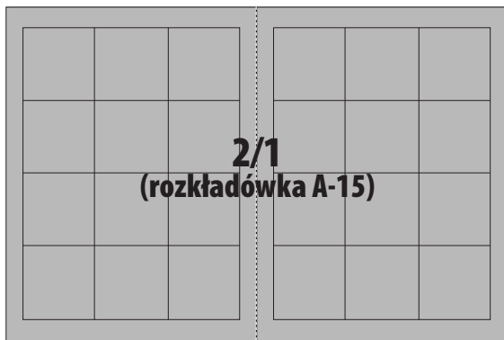
przed obcięciem ..... (2x) 220x282 po obcięciu ..... (2x) 210x272 pow. zadruku ..... (2x) 181x239
